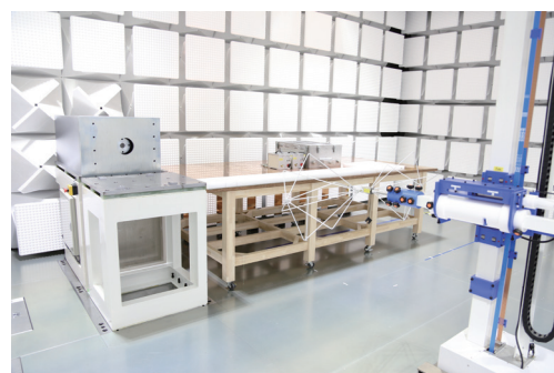
CISPR 25:2016 Ed.4 Annex I対応 固定型ダイナモ搭載電波暗室「EHV Chamber」
